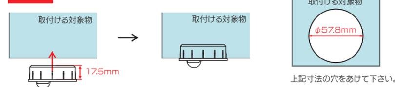
キャスターを製品に埋め込む様に取付けます。埋め込む部分の寸法は、高さ17.5mm以上 穴径φ57.8mmを取って下さい。
