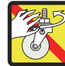
**ねじ込み式キャスターを取付ける際は、必ずスプナを用いステムの六角部で締め付けて下さい。**
