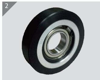
SHUTTLE 車輪 (PPDI+ESD) D80×W18 (アルミニウムコア)
